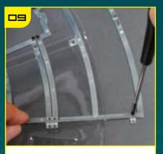
Зафиксируйте внешний фланец ребра жесткости на раме TF-29.
