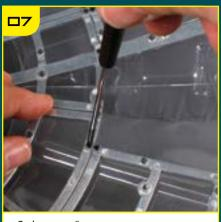
Зафиксируйте накладку с помощью винтов.
