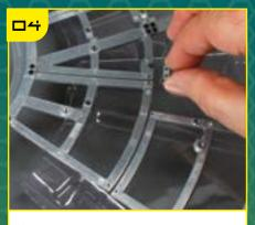
Установите соединительную накладку с двумя отверстиями на стыке рам TF-31 и TF-28.
