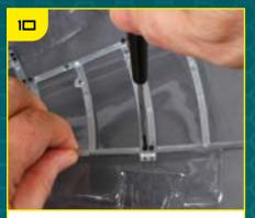
Зафиксируйте внутренний фланец ребра жесткости на стыке рам TF-29 и TF-30.
