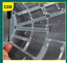
Зафиксируйте раму TF-31, закрутив винты в кольцо турели.
