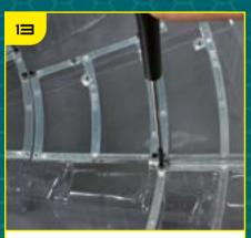
Зафиксируйте раму ТF-32, закрутив винт во внутренний фланец ребра.
